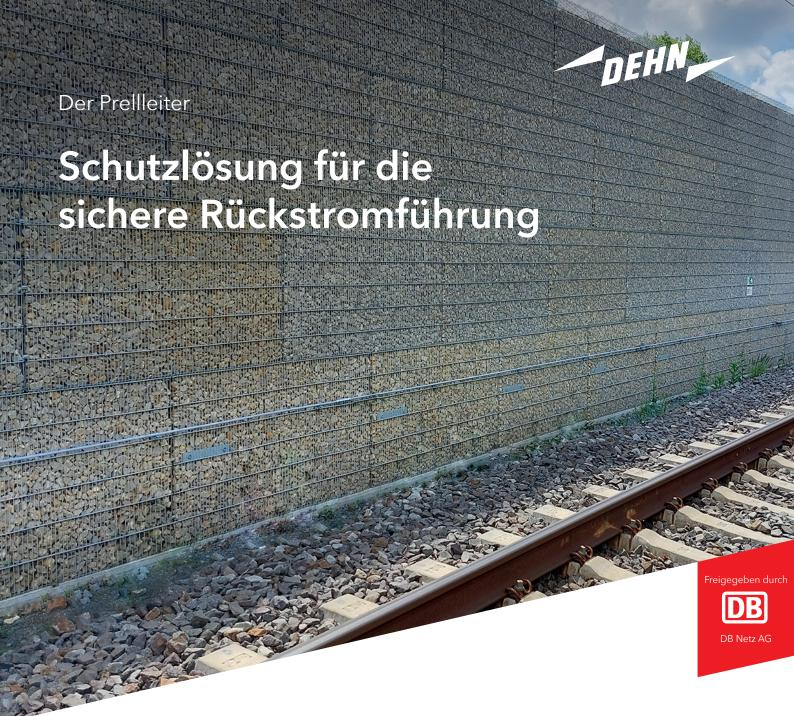
In der Bahninfrastruktur im Oberleitungsbereich wird nach DIN EN 50122-1 der Schutz an ganz oder teilweise leitfähigen Bauwerken gegen elektrischen Schlag gefordert. Für die Schutzlösung Prellleiter wurde für die Befestigung und Ausführung an Zäunen und Lärmschutzwänden eine von der DB Netz AG freigegebene Regellösung erarbeitet.
